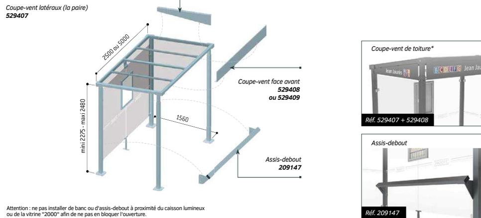
Attention : ne pas installer de banc ou d'assis-debout à proximité du caisson lumineux ou de la vitrine "2000" afin de ne pas en bloquer l'ouverture.
