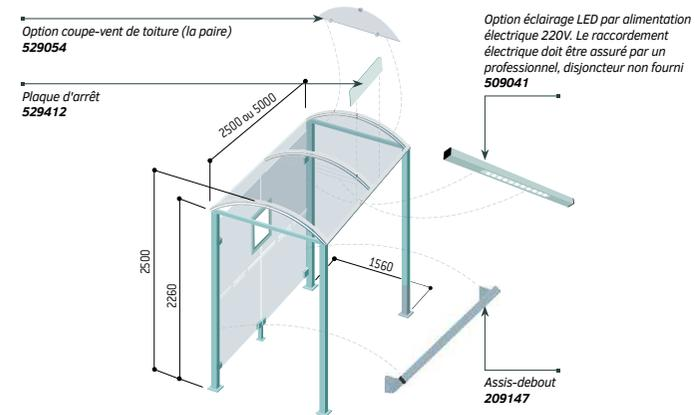
Attention : ne pas installer de banc ou d'assis-débout à proximité du caisson lumineux ou de la vitrine "2000" afin de ne pas en bloquer l'ouverture.
