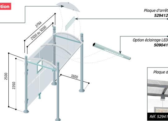
Attention : ne pas installer de banc ou d'assis-debout à proximité du caisson lumineux ou de la vitrine "2000" afin de ne pas en bloquer l'ouverture.
